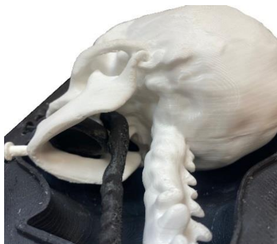
Рисунок 11. Череп с нижней челюстью с установленными вставками в литевой форме Figure 11. Skull with lower jaw with inserts installed in a cast mold
